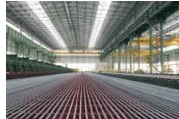
Kühlbett mit Hochgeschwindigkeits-Auflaufsystem HSD®
