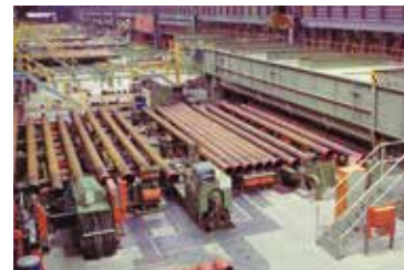
Rohrprüfpresse mit Muffenaufschrauber
