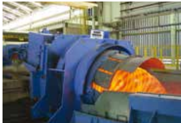
Windungsleger mit Windungskühltransport (LCC®)
