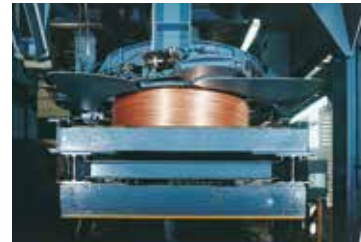
Windungsleger mit Ringvorsammelkammer für Drahtcoils bis 5 t
