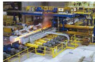
BD Gerüst in CCS®-Bauweise
