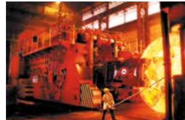
Freiform-Schmiedepresse mit Manipulator
