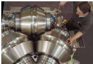
Justieren der Walzen eines Streckreduzierwalzwerkes (SRW)
