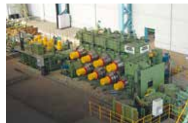
H + V-Richtanlage für Schienen
