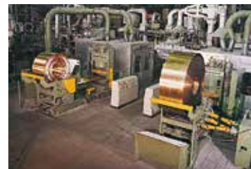
Horizontale Stranggießanlagen für kaltwalzfähige Bänder
